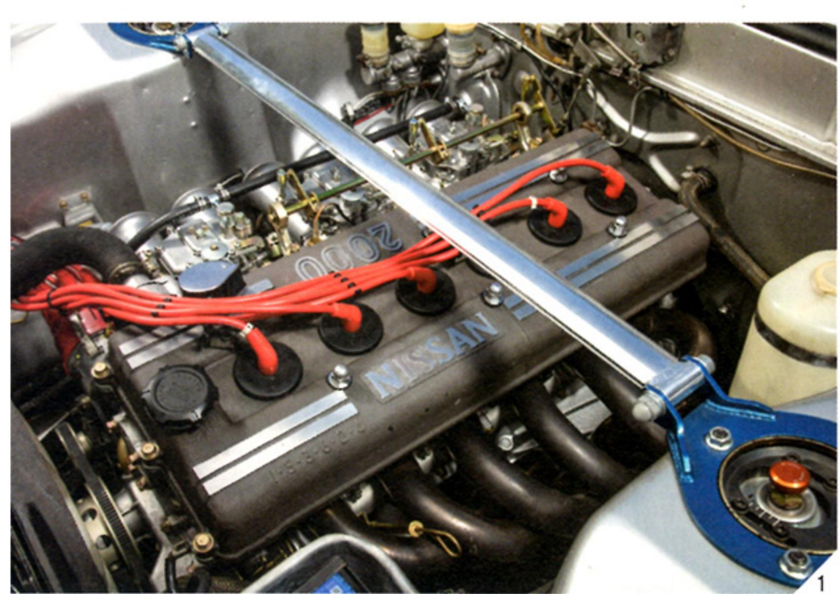
1.一見しただけなら普通のS20型エンジンだが、クランクシャフトとピストンを変更して2.6リッターにまでスープアップしている。等長エキゾーストとマフラーはワンオフだ。
