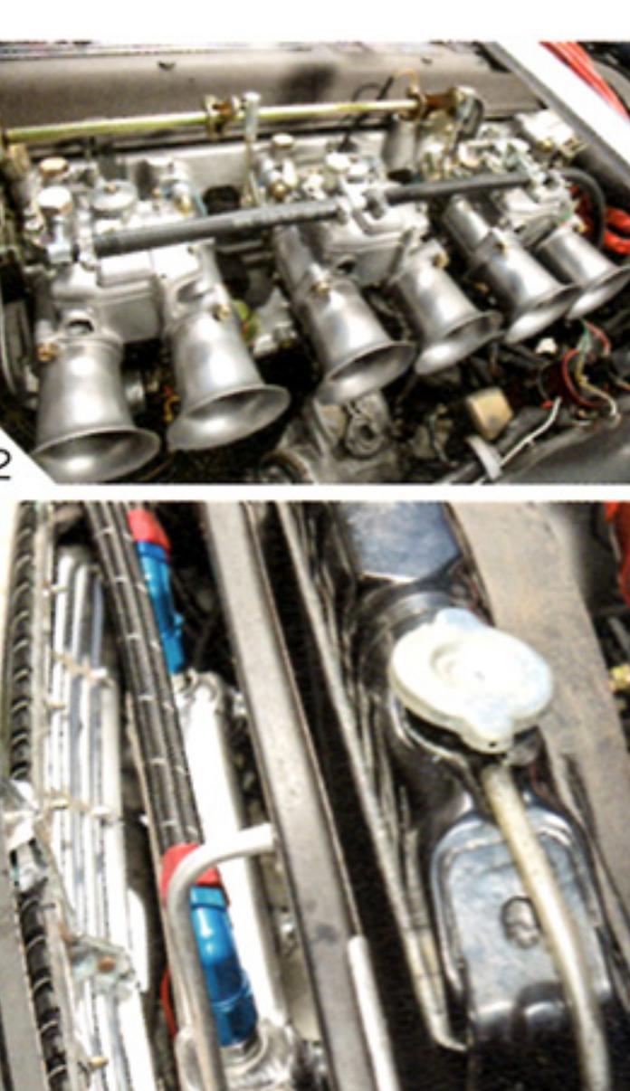
2.排気量を引き上げたのでキャブレターも口径の大きなソレックス44φにしている。アクセルリンクージは純正を再メッキするという手のこんだ修復がされている。
